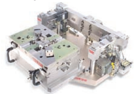
Auch komplexe Werkzeuge lassen sich mit Hilfe der Rahmentechnik schnell und sicher auf der Maschine wechseln.
